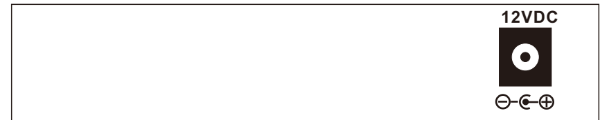
图17: HA7200 ONU后面板(外置电源)
