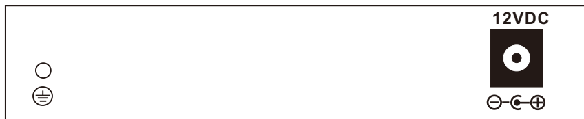
图20: HA7208 ONU后面板 (外置电源)
