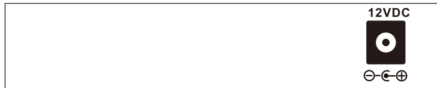
图13: HA7200D后面板(外置电源)
